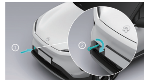
Plassering av kroken
