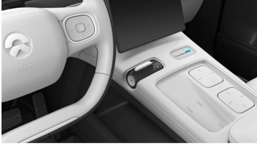
عند إلغاء قفل السيارة بالكامل وإغلاق جميع الأبواب، اضغط على زر القفل الموجود في الكونسول المركزي لقفل السيارة. ستعرض شاشة العرض المركزية حالة قفل السيارة، وسيضيئ مؤشر LED الموجود على الزر باللون الأخضر. عندما تكون السيارة مقفلة بالكامل (ليس من الخارج) أو إلغاء قفل باب السائق فقط، اضغط على زر القفل الموجود في الكونسول المركزي لإلغاء قفل السيارة. ستعرض شاشة العرض المركزية حالة إلغاء قفل السيارة، وسيينطفئ مؤشر LED الموجود على الزر.
