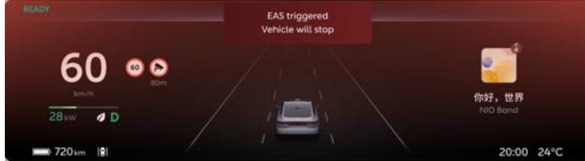
عند تنشيط نظام التوقف النشط في حالة الطوارئ (EAS)، ستصدر سيارتك صوت تحذيري مسموع، وتحذيراً صوتياً، وتنبهياً لنظام محاكاة البيئة الديناميكية وعرضها (ESD)، وتضيء أضواء التحذير من الخطر. سينبهك النظام للتحكم في سيارتك عن طريق الفرملة المتواصلة وإصدار تنبيهات عالية إلى أن تتوقف السيارة. بعد توقف السيارة، ستُفتح الأبواب تلقائياً وتُستدعى خدمات الإنقاذ في حالات الطوارئ.
