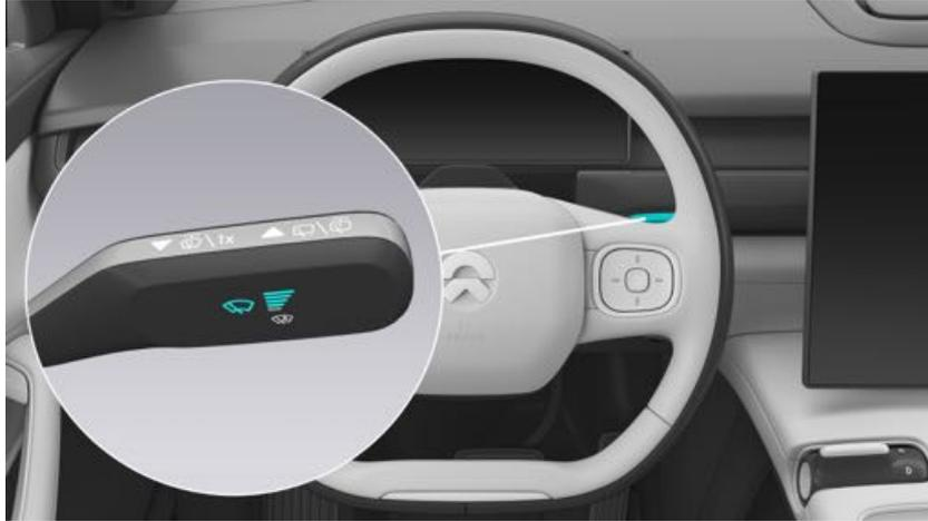
فم بتحريك ذراع التحكم بالمسحات للأعلى لتشغيل المسحات. تتم زيادة سرعة المسحات في كل مرة يتم فيها تحريك الذراع خطوة واحدة، علمًا أنّ السرعة القصوى تكون عند الوصول إلى المستوى 4. عندما تتم إعادة ذراع التحكم بالمسحات إلى وضعيته الأصلية، يتم إيقاف حركة المسحات.
