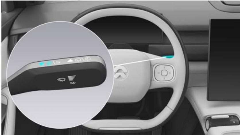
**نفث ومساحة:** قُم بتحريك ذراع التحكم بالماسحات باتجاه جانب السائق باستمرار لكي تقوم الفوهات الموجودة على أذرع الماسحات بنفث الماء بينما تقوم الماسحات بمسح الزجاج الأمامي بسرعة منخفضة. حرّر ذراع التحكم بالماسحات لإيقاف نفث الماء. تستمر الماسحات في المسح ببطء ثلاث مرات ثم تتوقف لمدة ثانيتين ومن ثم تقوم بالمسح مرة واحدة.
